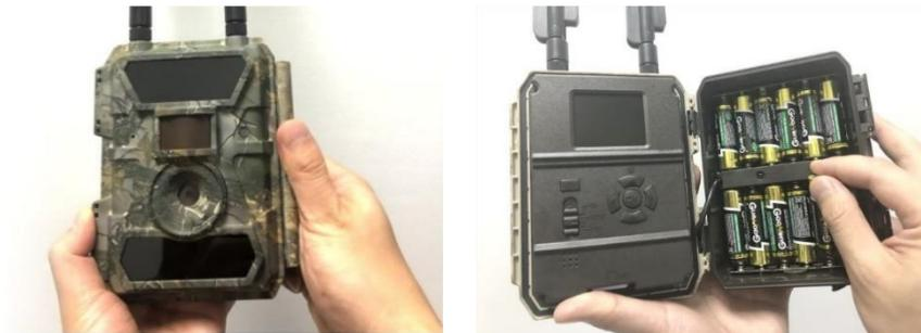
Åpne kamerahuset og sett inn batteriene som angitt i batterirommet.
