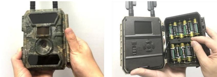
Åbn kameraet, og sæt batterierne på plads i batterirummet. Vær opmærksom på polariteten som markeret i batterirummet.
