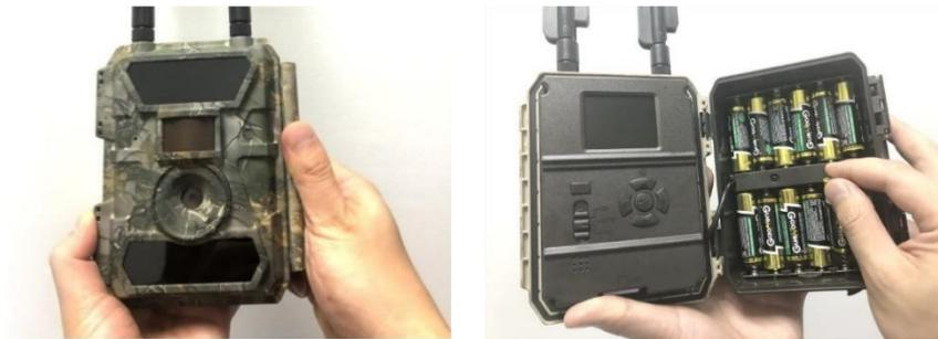
Öppna kamerahuset och sätt i batterierna enligt den polaritet som är markerad i batterifacket.
